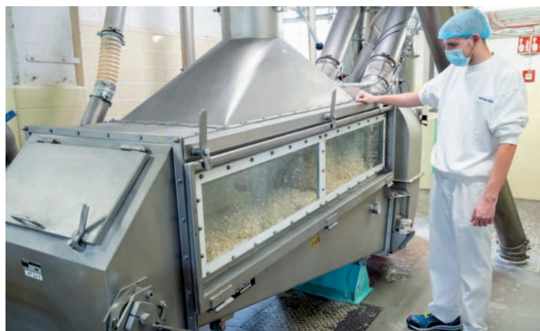
Gereinigt, gesäubert, gewalzt, gedarrt, erhitzt und wieder abgekühlt: Der Hafer durchläuft sechs Produktionsböden auf dem Weg zur Flocke.
